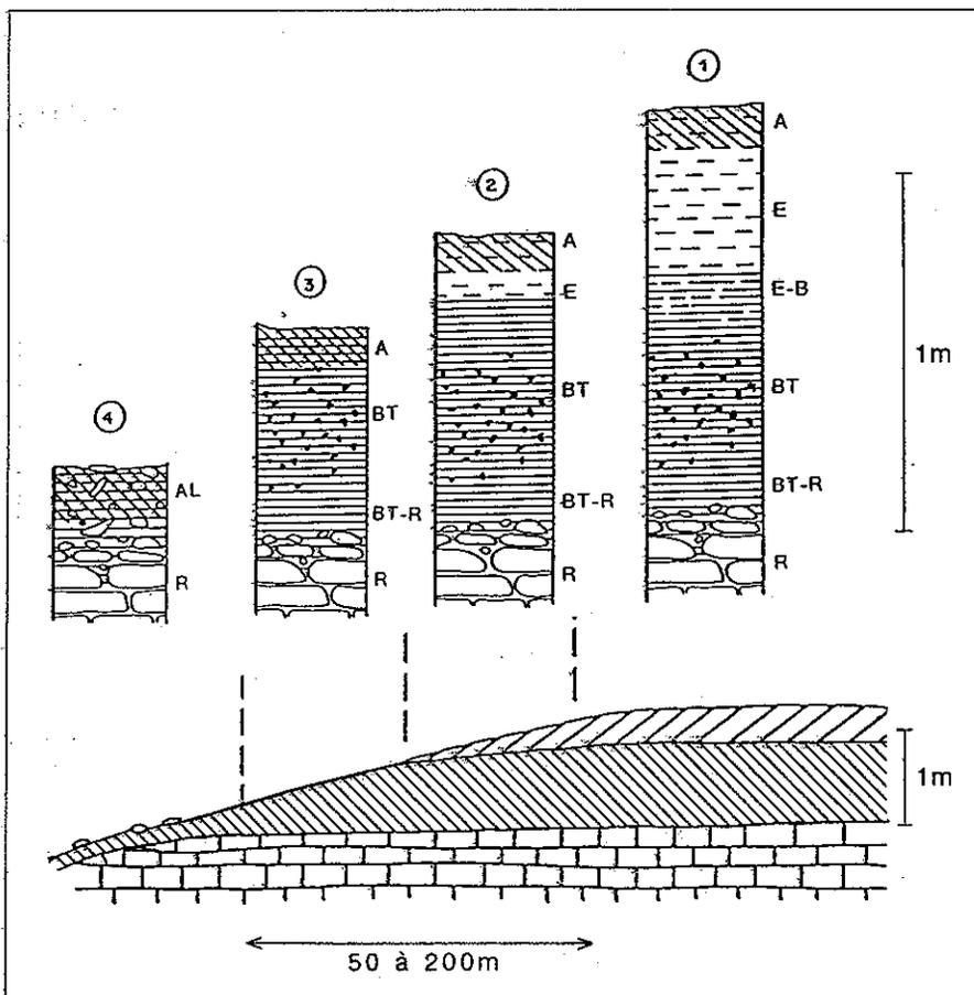
Figure 2 : Toposéquence schématique des "Terres d'Aubues".
